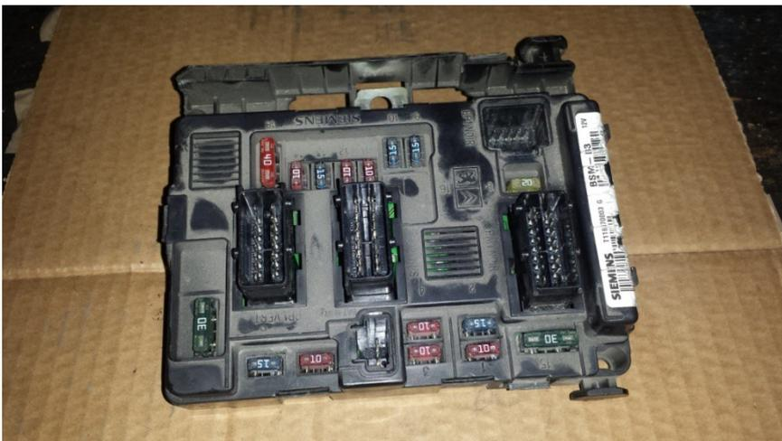
La unidad PSF a parte de ubicar los fusibles lleva integrado el relé de la bomba de combustible, que en este caso es el que no se activa.
